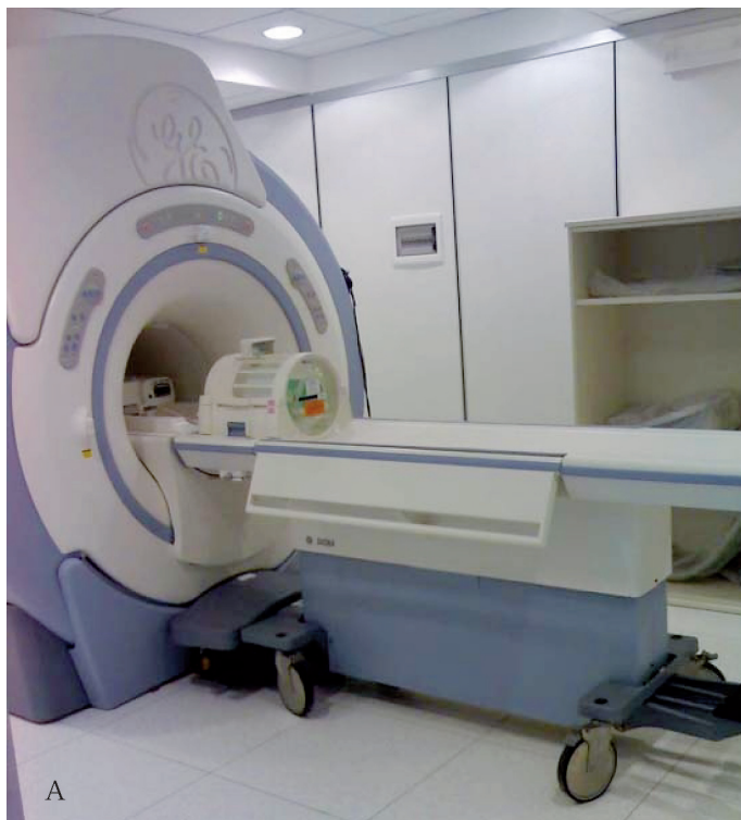
Fig. 10. UNITÀ DI RISONANZA MAGNETICA. La MRI permette di acquisire in ogni scansione immagini sul piano trasversale, sagittale e coronale sfruttando il fenomeno fisico conosciuto come risonanza magnetica nucleare . L'apparecchiatura di MRI è costruita con un potente magnete entro il quale viene introdotto il corpo del paziente (A). All'interno del magnete si genera un campo magnetico che è orientato secondo l'asse principale B_0 , del magnete stesso (B).
