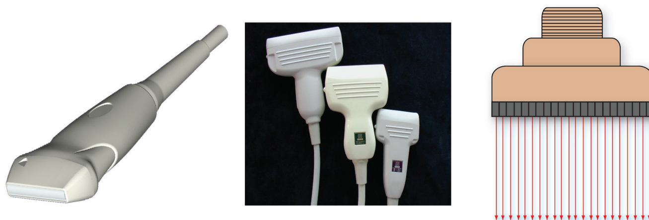
Fig. 68. SONDA LINEARE. Questo tipo di trasduttore è costruito con barrette rettangolari di ceramica piezoelettrica, disposte in modo lineare. Il numero degli elementi, e quindi le dimensioni complessive della sonda, variano in funzione delle scelte progettuali delle aziende costruttrici e delle applicazioni cliniche.
